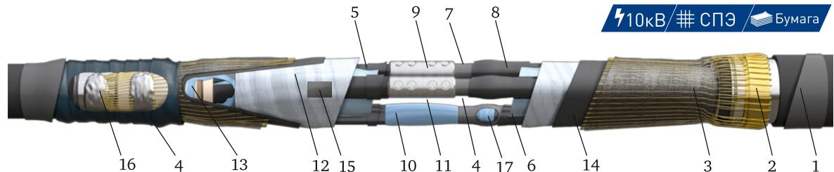
Переходные кабельные муфты типа 3 СПтп-10 (БПИ Зж-СПЭ Зж) предназначены для соединения силовых 3-жильных кабелей с бумажной маслопропитанной изоляцией и 3-жильных силовых кабелей с изоляцией из сшитого полиэтилена с ленточной броней или без брони с медным проволочным экраном на напряжение 6-10 кВ.
