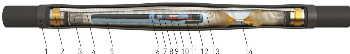
Муфты 3 ПСТ6-10 предназначены для соединения 3-жильных силовых кабелей с изоляцией из сшитого полиэтилена на напряжение до 10 кВ.
